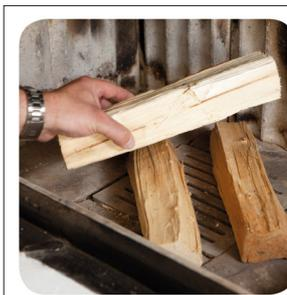
Das Holz locker in den Brennraum schichten.
